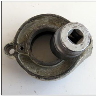
Utilisez un objet cylindrique de 50 mm ou un peu moins, pour chasser les joints (par l'arrière).
