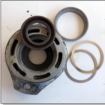
*Bien enfoncer successivement les deux joints (par l'avant) pour que leurs faces planes se touchent. Utiliser un objet cylindrique et frapper légèrement avec un marteau tout en veillant à ce que les joints restent dans l'axe sans les abîmer.*
