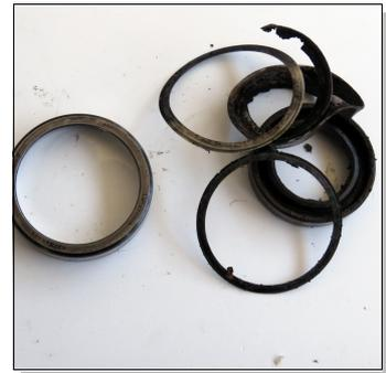
On extrait la bague conique, les deux joints et les deux anneaux espaceurs. En principe la bague conique est récupérable
