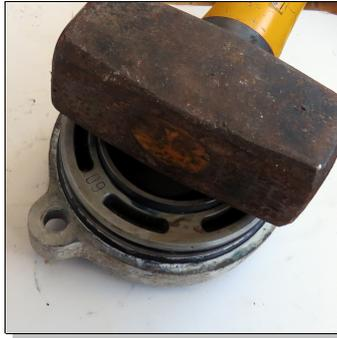
*Bien graisser la cage et la bague. Placer les espaceurs et la bague conique. Utiliser la masse (par exemple) et un marteau pour que la bague reste bien dans l'axe.*
