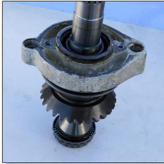
*Graisser l'axe. Poser l'ensemble verticalement sur une surface horizontale. Enfiler la cage sur l'axe sans forcer*
